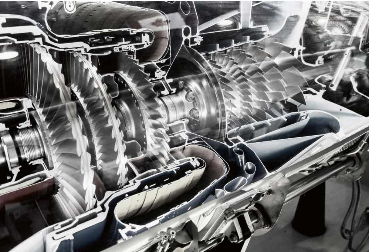
1 Verdichter- und Turbinenscheiben moderner Triebwerke bestehen aus hochfesten Materialien und weisen komplexe Strukturen auf (© PTW)
